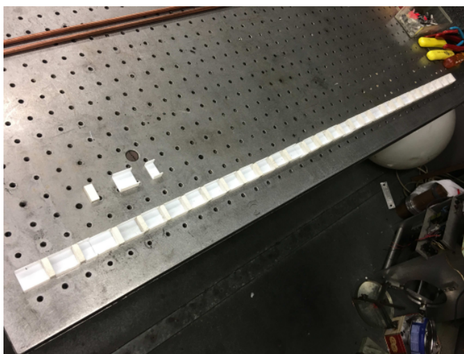
Figura 24.6: La guía de ondas electromagnéticas usada por A. Genack y colaboradores en el experimento que se menciona en el texto.
